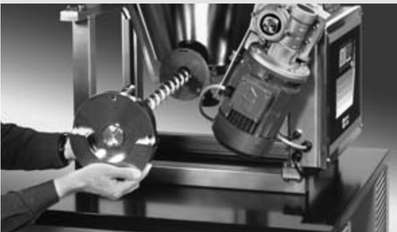
Ausbau der Schnecke
