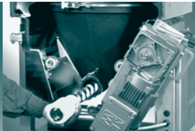
Ausbau der Schnecke
